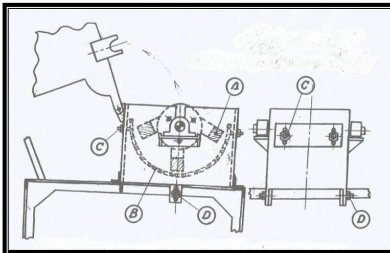
Les VIS (C) et (D) sont des VIS d'ajustage de la grille (B) lorsque les marteaux commencent à être usés.
