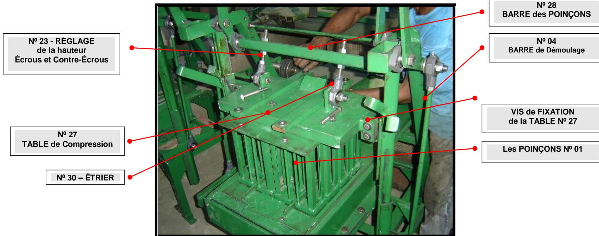
**PRESSaBLOCS – MOULE – Phase de Montage des POINÇONS**
