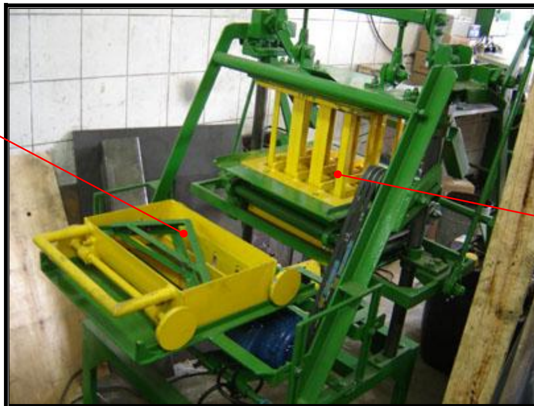
PHOTO d'Atelier – Machine à la livraison – Avec MOULE HOURDIS
