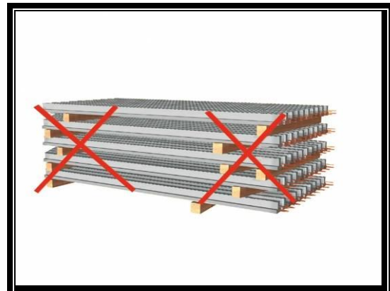
Mauvais stockage . à éviter
